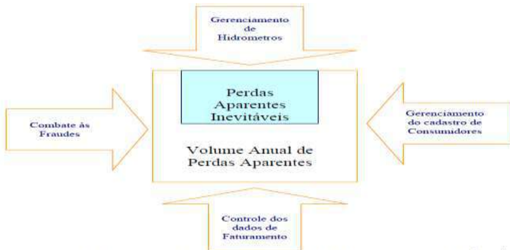
Figura 3 – Diagrama de gerenciamento de Perdas Aparentes de Água
