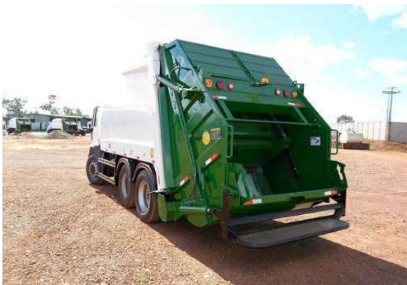
Modelo proposto de caminhão coletor e compactador Fonte: Internet
